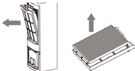
**Bemærk:** Når filtreringsnettet har været i brug længe, tilstoppes det med støv og snavs, som har stor indflydelse på apparatets ydeevne. Det anbefales at rengøre filtreringsnettet hyppigt.
